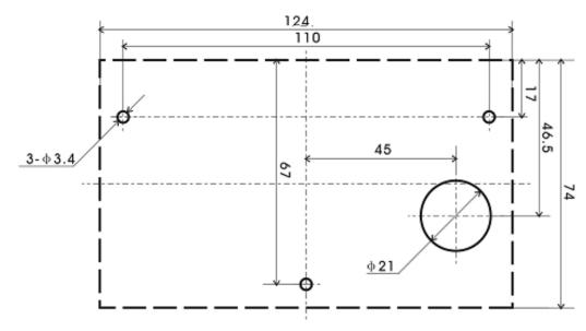
注: 虚线框为计数器显示部分的外形尺寸, 此图为柜门正面图。
